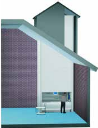
Installasjon gjennom eksisterende yttertak eller innertak.
