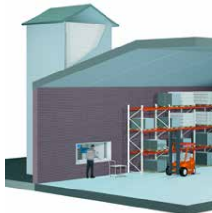
Installasjon utenfor bygget med betjeningsåpning på innsiden.
